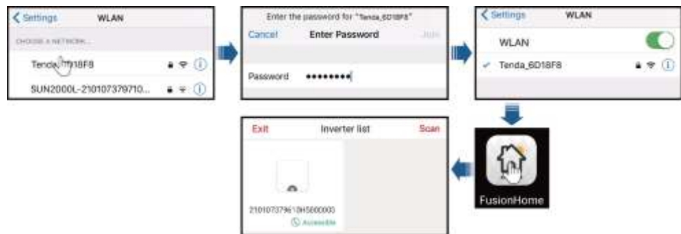
Figura 7-9 Telefono cellulare che si connette al SUN2000L tramite un router
