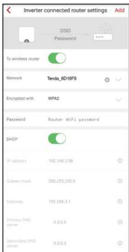
Figura 7-35 Impostazioni del router connesso all'inverter
