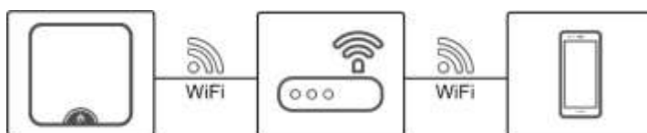
Figura 7-2 Telefono cellulare che si connette al SUN2000L tramite un router
