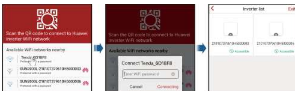
Figura 7-7 Telefono cellulare che si connette al SUN2000L tramite un router
