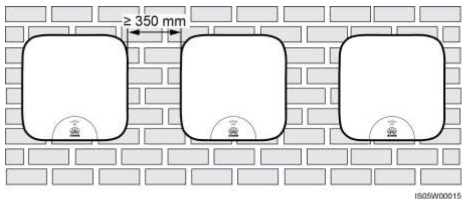
Figura 4-3 Modalità di installazione in posizione orizzontale (consigliata)
